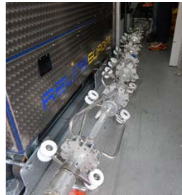
Figura 4.1.5 treno di lampade UV (Reline Europe)
